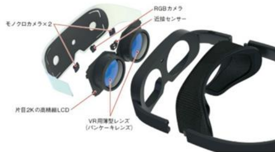
図2 HMDの構造図
